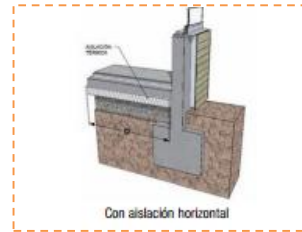
Piso con aislante horizontal
