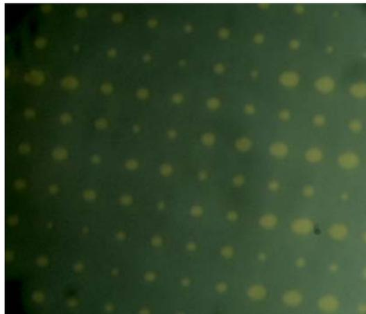
Figura A.3: Puntos de oro fabricados utilizando un proceso de *Lift-off* estándar mediante el uso del sistema de litografía directa para exponer la resina fotosensible.
