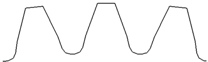
Figura 6. Dientes con perfil de involuta
