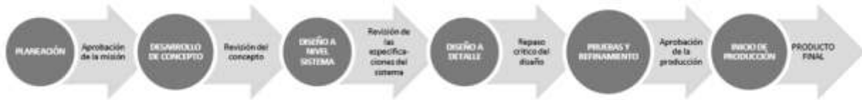
Ilustración 6. Proceso de diseño genérico para obtención del producto. Karl T. Ulrich "Diseño y desarrollo de productos" pp.26. Cuarta edición 2008
