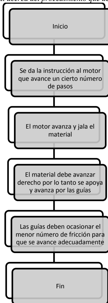
Ilustración 31. Diagrama general acerca del procedimiento que debe llevar a cabo la máquina CNC.
