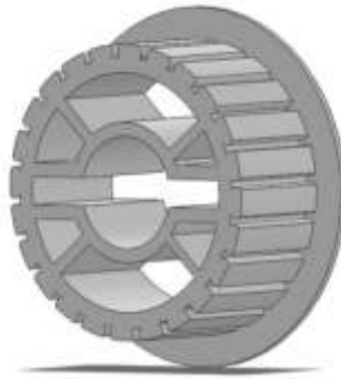
Ilustración 60. Polea dentada para unir el eje con el motor pasó a paso. Autor.
