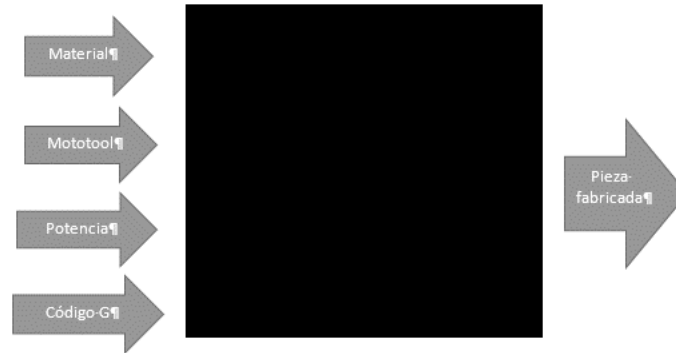
Ilustración 14. Caja negra, entradas y salidas generadas a partir del Router CNC. Autor.
