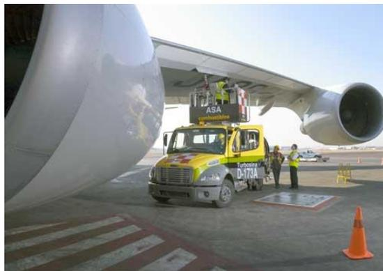
*Ilustración 3.9 Hidrotanque conectado a hidrante. Fuente: [www.asa.gob.mx](http://www.asa.gob.mx)*
