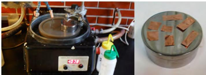
Figura 3-1: Izquierda: pulidora mecánica (UNIPOL-810 Precision Lapping Machine MTI Corporation) con la que se logra homogeneizar la superficie de los sustratos de cobre propiciando mejorías en la respuesta mecánica de las muestras de multigrafeno. Derecha: laminillas de cobre sin pulir.
