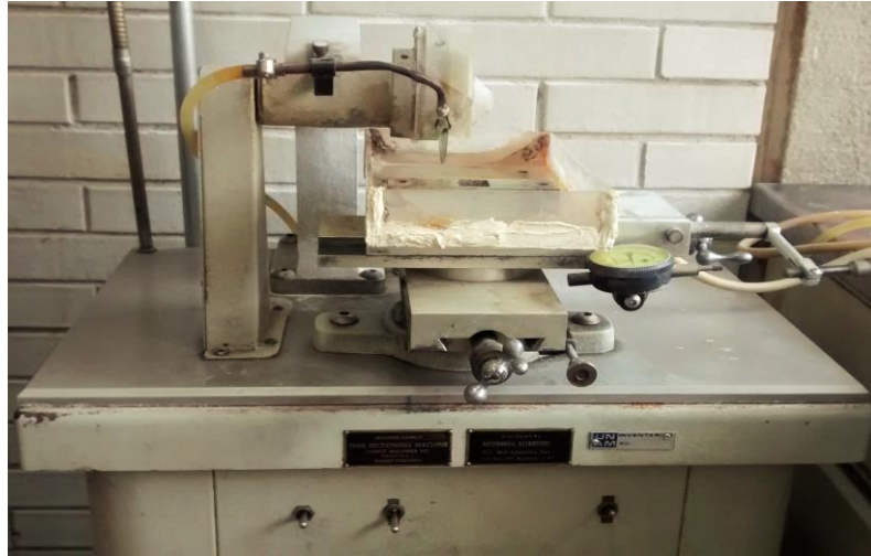
Fuente directa Imagen 13 Recortadora Gillengs-Hamco Thin. Sectioning Machine
