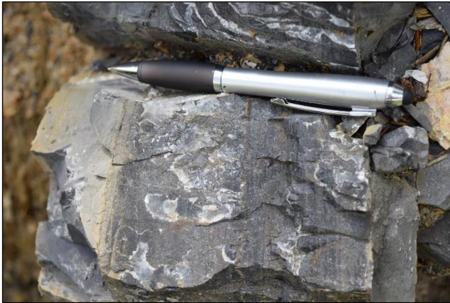
*Fotografía 6.19. Caliza arcillosa (derecha) en contacto con caliza limpia (izquierda) de la cima de la Formación Pimienta. Se observa que también la coloración de ambas litologías es diferente (Presa de Nuevo Necaxa, Puebla).*
