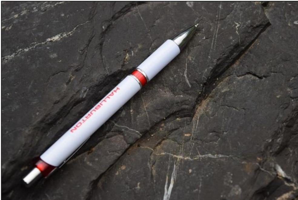
*Fotografía 6.14. Detalle de la lutita calcárea con alto contenido de materia orgánica con presencia de vetillas de calcita (Totolapa, Puebla).*
