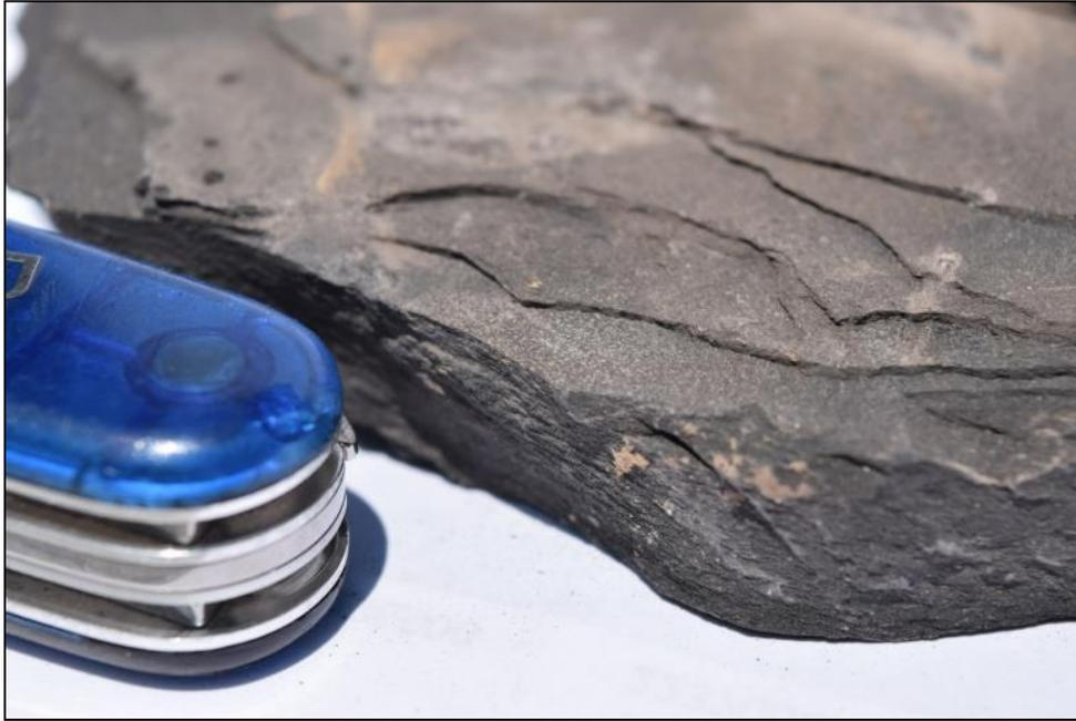
*Fotografía 5.14. Fotografía de muestra de mano de lutitas calcáreas de la Formación Agua Nueva, se observa el color al fresco y la estructura laminada (San Agustín, Puebla).*
