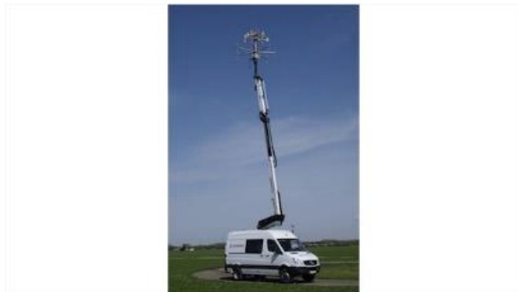
Figura 1-1 Radar Pasivo de la empresa Cassidian [3]
