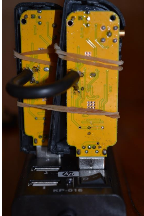
Figura 4-12. Cable coaxial utilizado para sincronizar ambos RTLSDR.
