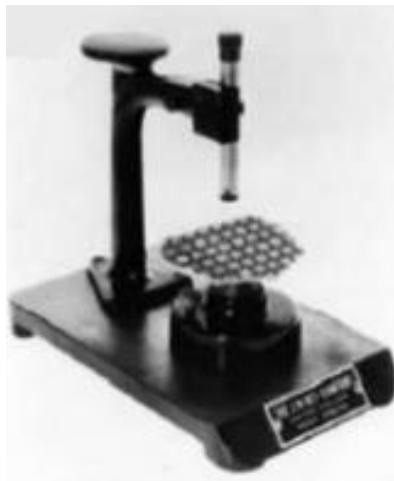
Fig. 20 Paralelómetro Ney Original creado en 1917 y fabricado hasta 1923.
