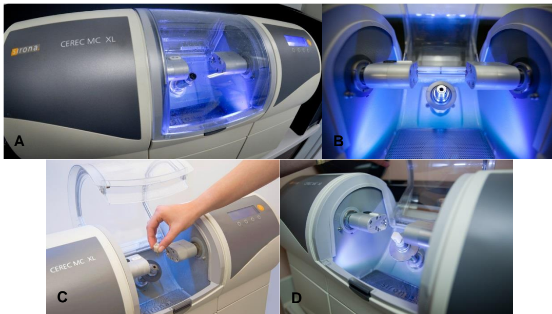
Figura 30. Fase CAM. A) Fresador CEREC MC XL® de Sirona®. B) Soporte del bloque. C) Colocación del bloque para el proceso. D) Inicio del maquinado. 29
