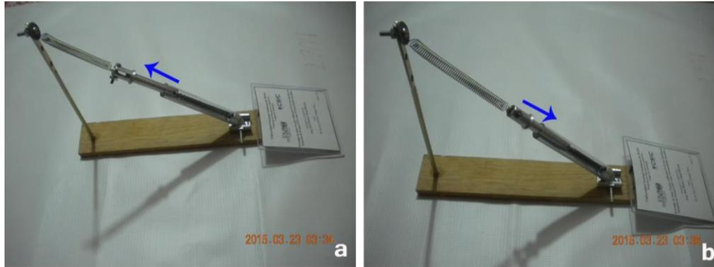
Figura 40-a) El resorte a temperatura ambiente tiende a estar estirado, manteniendo al émbolo desplazado. b) Cuando la temperatura del resorte está por arriba de los 50°C tiende a estar comprimido, manteniendo al émbolo al interior del tubo de vidrio.
