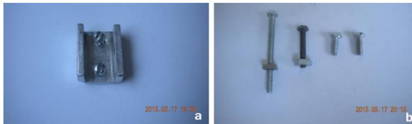
Figura 46.-a) Soporte de fijación; b) Tornillería utilizada.
