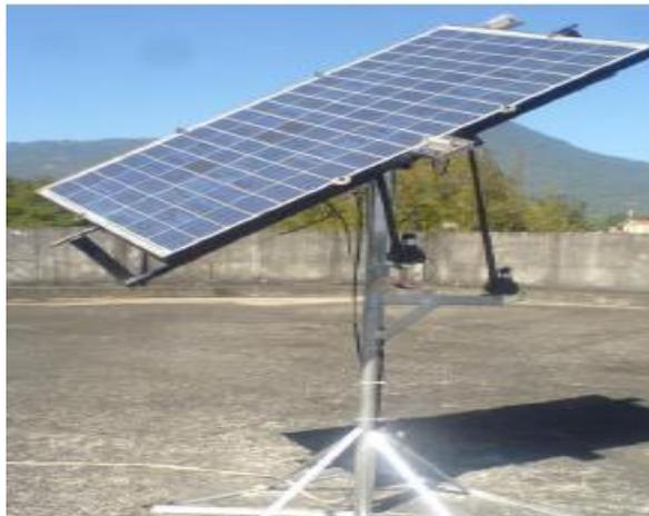
*Figura 21.- Prototipo de seguidor solar para la Escuela de Ingeniería Eléctrica de la UES. Fuente: Imagen recuperada de (Guardado et al, 2012), Implementación de seguidor solar en dos ejes para el Sistema Fotovoltaico de la Escuela de Ingeniería Eléctrica de la UES.*
