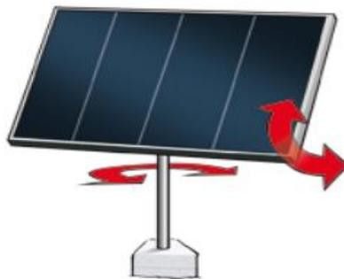
Figura 14.-Esquema de un seguidor de dos ejes. Fuente: Imagen recuperada de (Guardado et al, 2012), Implementación de seguidor solar de dos ejes para el Sistema Fotovoltaico de la Escuela de Ingeniería Eléctrica de la UES.
