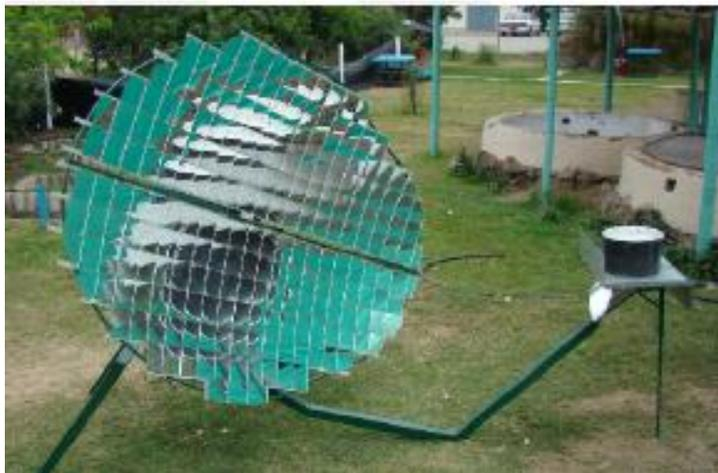
*Figura 22.-Seguidor solar para el control electrónico de un reflector scheffler. Fuente: Imagen recuperada de (Ochoa, 2012), Diseño e implementación de un seguidor solar para el control electrónico de un reflector scheffler.*
