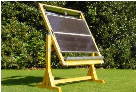
*Figura 18.- Seguidor solar pasivo Fuente: Fotografía recuperada de (Clifford 2004, pág. 277), Design of a novel passive solar tracker.*
