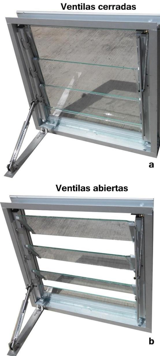
*Figura 56.-Nueva propuesta de la ventana inteligente, se ha utilizado el accionador solar como mecanismo cierre y apertura automática. **a)** Las ventilas, se mantienen cerradas cuando la temperatura del accionador es equiparable a la del ambiente; **b)** Las ventilas se muestran abiertas, posición que mantienen cuando la temperatura del accionador está por arriba de los 50°C.*
