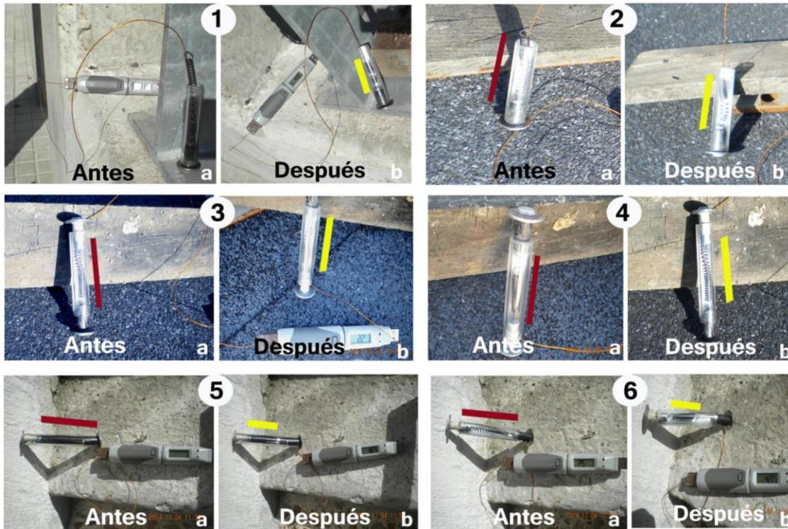
Figura 34.-Proceso experimental de las pruebas de concentración. Se presenta del lado izquierdo [figura a] el estado inicial del resorte antes de comenzar la prueba >línea en color rojo<; Del lado derecho [figura b] se muestra el estado del resorte finalizado el tiempo de exposición >línea en color amarillo<.
