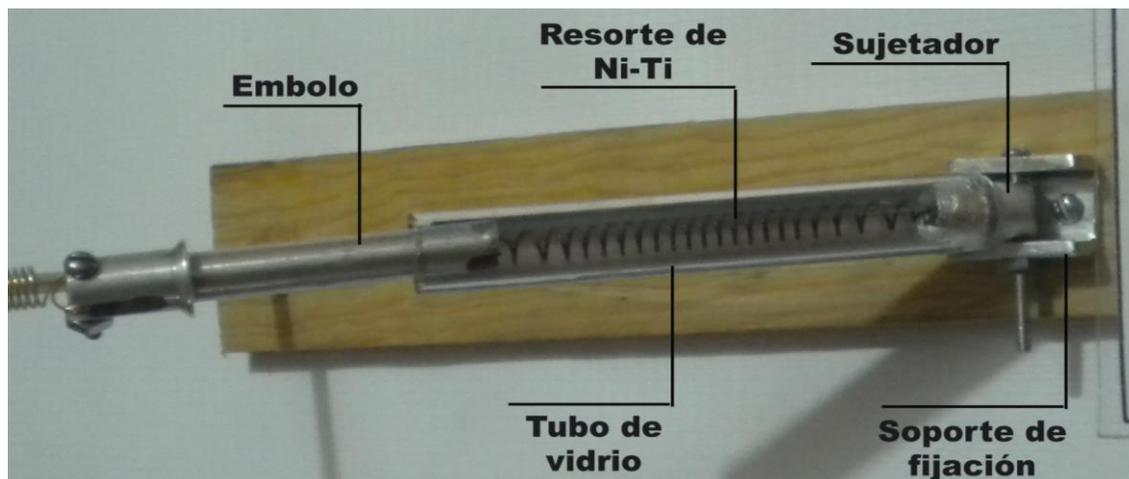
Figura 47. Accionador solar ensamblado e identificando cada una de sus partes.
