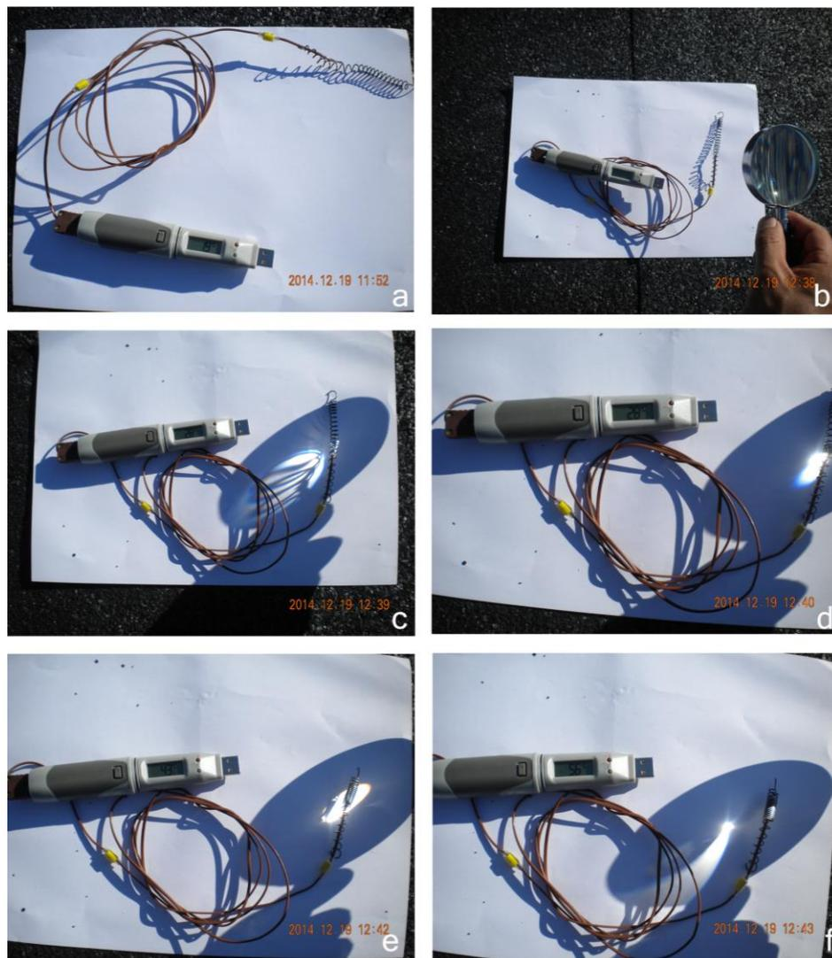
*Figura 25.-a) Estado del resorte de Ni-Ti antes de la prueba; b) Desviación la luz sobre un punto focal; c) El resorte comienza a contraerse aproximadamente a los 29°C; De la figura >d a f< se muestra el resorte recuperando su forma.*
