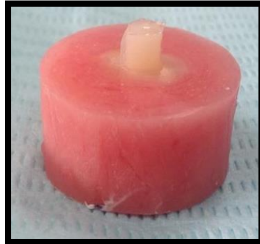
Fig. 10 y 11 Se retiró el aditamento y se obtuvo el botón de cemento de 4mm de diámetro.
