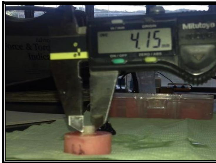
Fig. 19 Se midió el diámetro de cada muestra.
