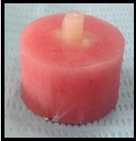
Fig. 17 y 18 Se retiró el aditamento y se obtuvo el botón de cemento de 4mm de diámetro, las muestras se guardaron en agua bidestilada.
