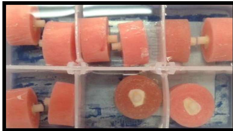
Fig. 12 Se obtuvieron las muestras del grupo A RelyX U200® y se guardaron en agua bidestilada.
