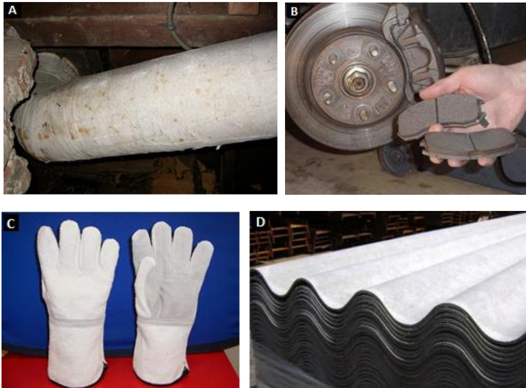
Figura 2.10. Diversos productos hechos con asbesto. Tubería forrada en papel de asbesto (A). Productos de fricción: pasta de frenos (B). Guantes ignífugos (C). Tejas (D).
