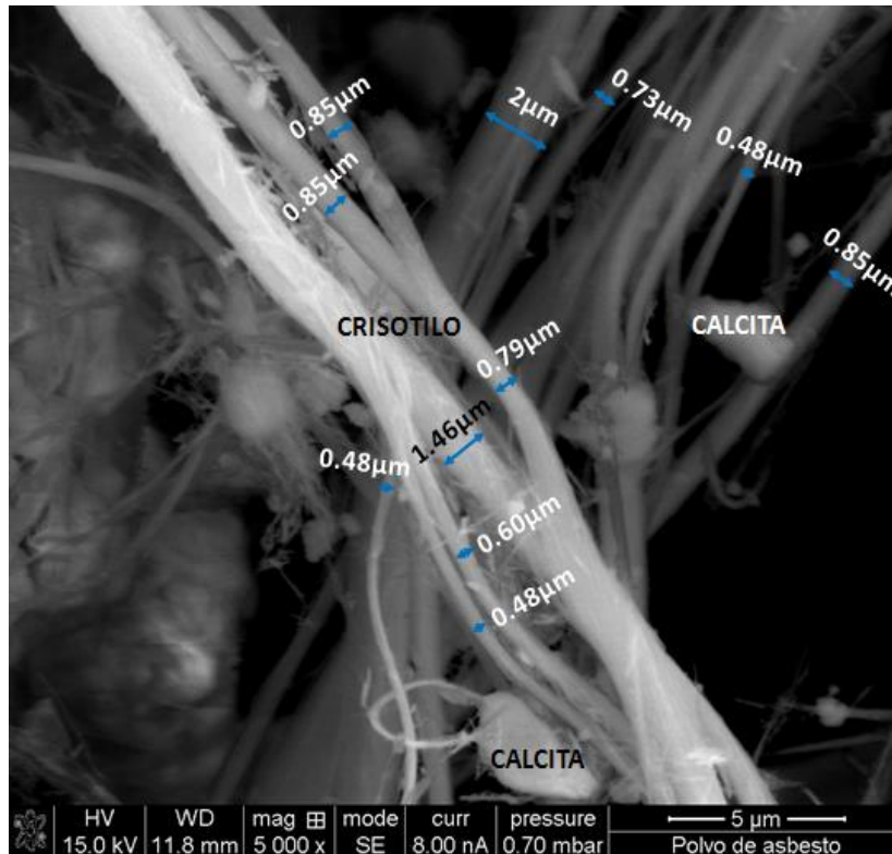
Figura 4.35.A. Fibra de crisotilo a 5 μm. Tales fibras tienen longitudes mayores a 5 μm y exhiben diámetros de 0.48 a 2 μm. Aunados a las fibras se aprecian pequeños cristales de calcita.
