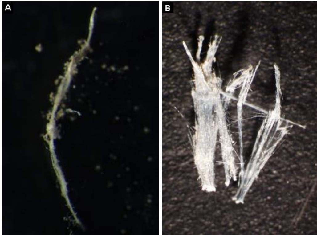
Figura 4.68. Fibra de crisotilo en la muestra Barrientos S17 en (A). Conjunto de fibras de anfíbol en la muestra Barrientos S17 (B).
