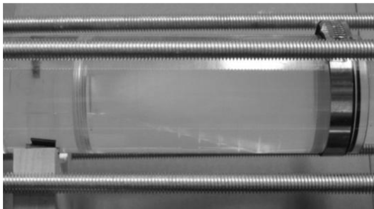
Fig. 36 Imágenes del fenómeno de la cavitación al 38% de la potencia de la bomba con cámara NIKON.
