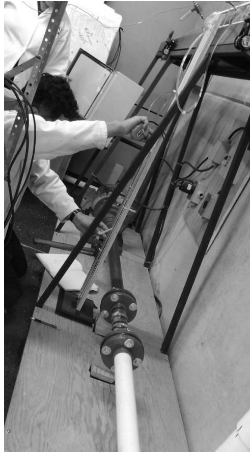
Fig. 43 Adquisición de datos en manómetro
