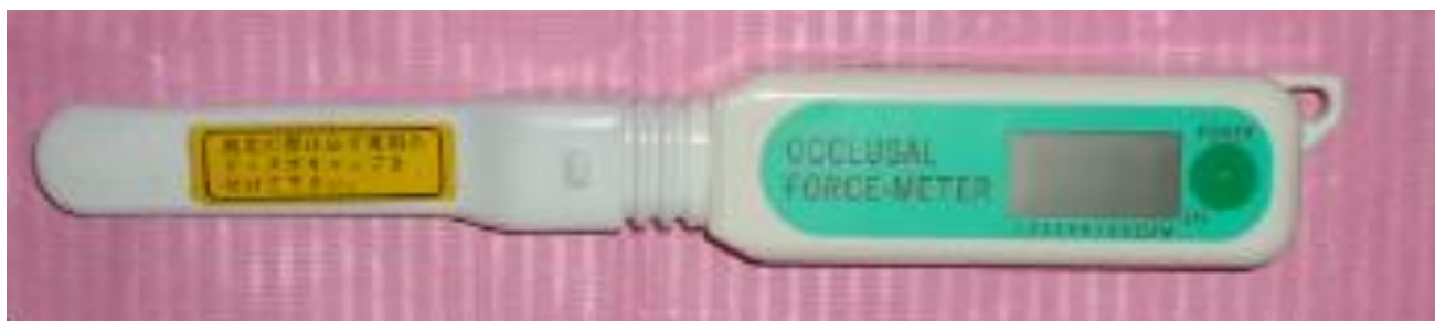
Figura 8.5. Transductor de fuerza oclusal portátil. Para registrar la máxima fuerza oclusal se coloca la punta de trabajo en los primeros molares permanentes o en el borde de incisivos permanentes. La fuerza oclusal es reportada en Newtons.
