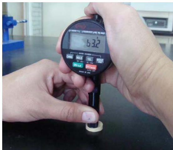
Figura 8.8. Durómetro para silicona. Para evaluar la dureza de una tableta de silicón se realizan 5 mediciones en ella (una en el centro y cuatro en las orillas). El promedio de las 5 mediciones se considera la dureza de la tableta.
