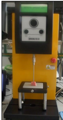
Figura 17. Texturómetro Brookfield® CT3 realizando prueba de compresión.
