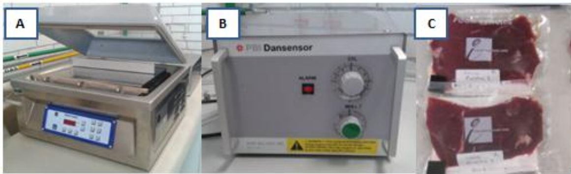
Figura 13. a) Equipo MULTIVAC b) Equipo mezclador de gases Dansensor ® c) Carne envasada en atmósfera modificada.
