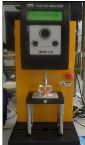
Figura 18. Texturómetro Brookfield® CT3 realizando prueba de punción.
