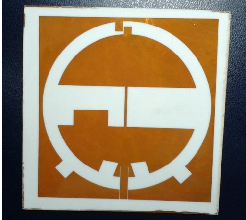
Figura 4.6 Antena implementada sobre el sustrato a) Primer Diseño b) Segundo Diseño
