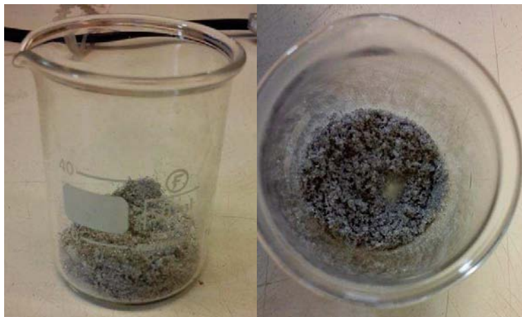
Figura 3.7 Vaso de precipitados número 2, mezcla de NaCl y polvo de Mg antes de ser disuelta
