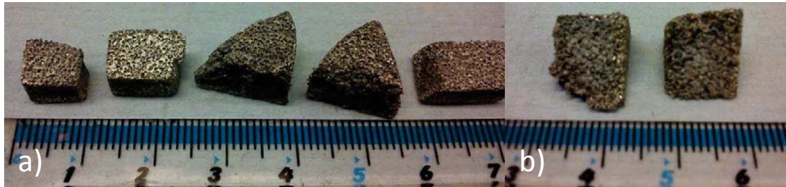
Figura 3.22 a) espumas de Mg después del proceso de lixiviado y b) espuma cortada por la mitad después de la eliminación del NaCl
