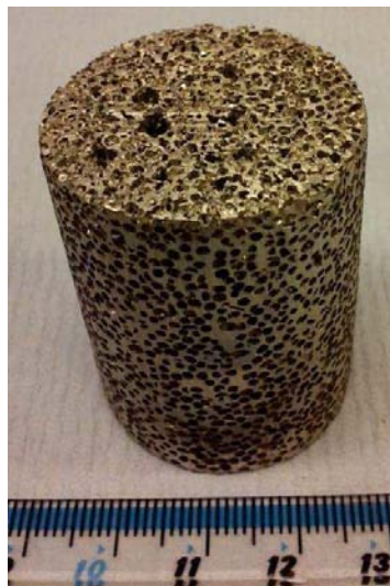
Figura 3.4 Espuma de magnesio después de un exitoso proceso de lixiviado del NaCl
