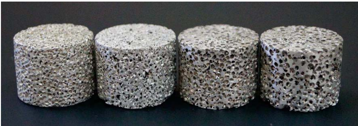
Figura 3.28 Espumas maquinadas y disueltas para medición de densidad y porosidad
