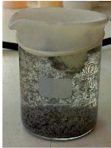
Figura 3.9 Vaso de precipitados número 3, NaCl y polvo de Mg en la solución de NaOH con pH de 13
