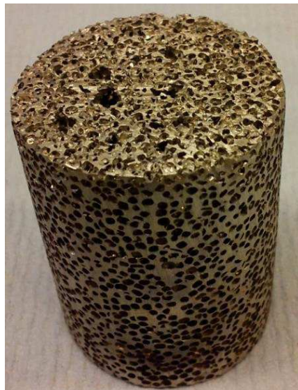
Figura 3.24 Espuma de magnesio completamente libre de material de sacrificio
