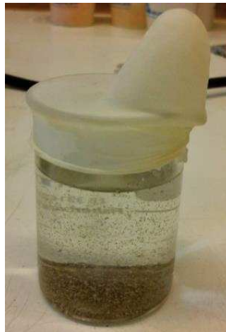
Figura 3.5 Vaso de precipitados número 1, NaCl y polvo de Mg en agua a temperatura ambiente
