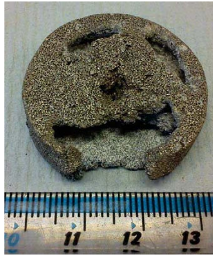
Figura 3.23 Espuma de mayor tamaño, después del proceso de lixiviado
