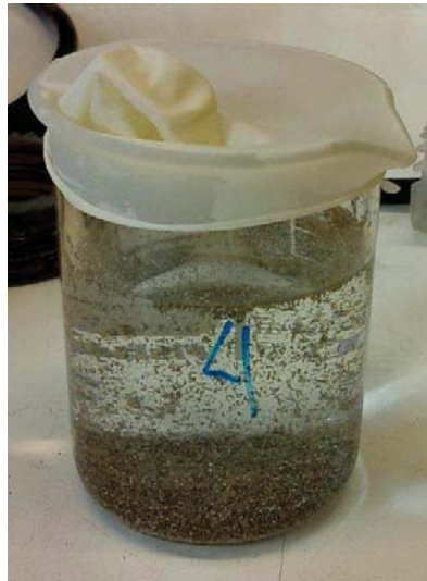
Figura 3.10 Vaso de precipitados número 4, polvo de Mg en agua a temperatura ambiente
