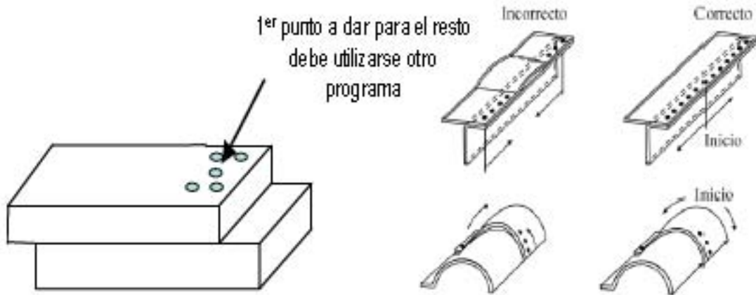
Figura 2.12. Forma de aplicación de los puntos de soldadura.
