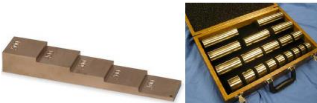
Figura 3.36. Patron de medicion de espesores.
