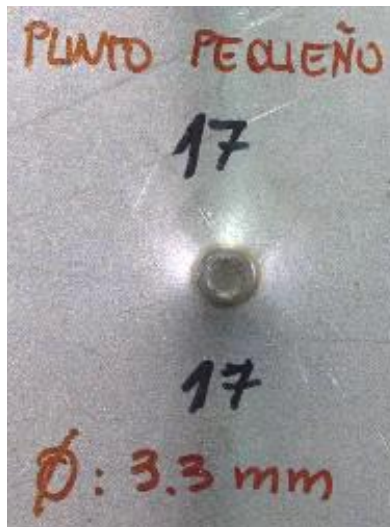
Figura 4.5 y 4.6, respectivamente, las cuales muestran un punto pequeño (menor al espesor requerido y punto de soldadura quemado
