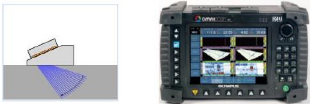
Figura 3.32. Configuración Phased Array Sectorial.
