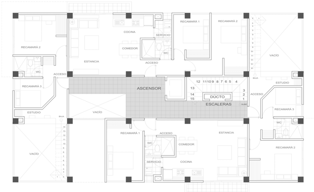
SEGUNDO PISO EDIFICIO TIPO 1
