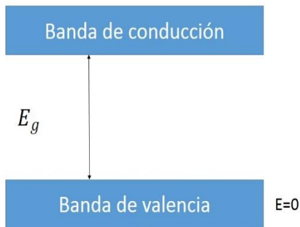
Figura 3. Un semiconductor macroscópico tiene bandas de conducción y valencia continuas separadas por una brecha energética cuyo E_g valor depende de la identidad del material.
