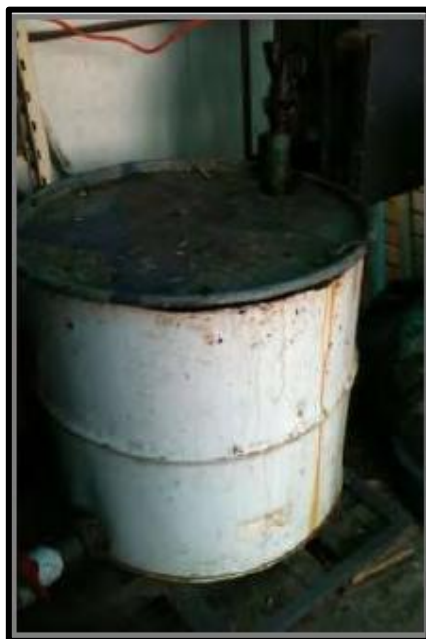
Figura 3.11 Tanque receptor de la materia prima triturada (Grimaldo, 2013)
