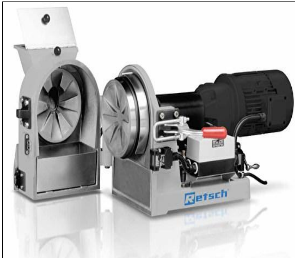
Figura 2.9 Molino de discos (Restch, 2015)
