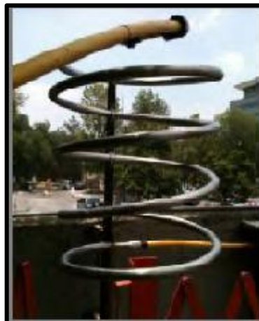
Figura 3.16 Condensador de humedad (Grimaldo, 2013)
