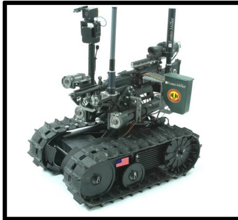
Figura 23. Locomoción tipo cadenas o skidsteer
