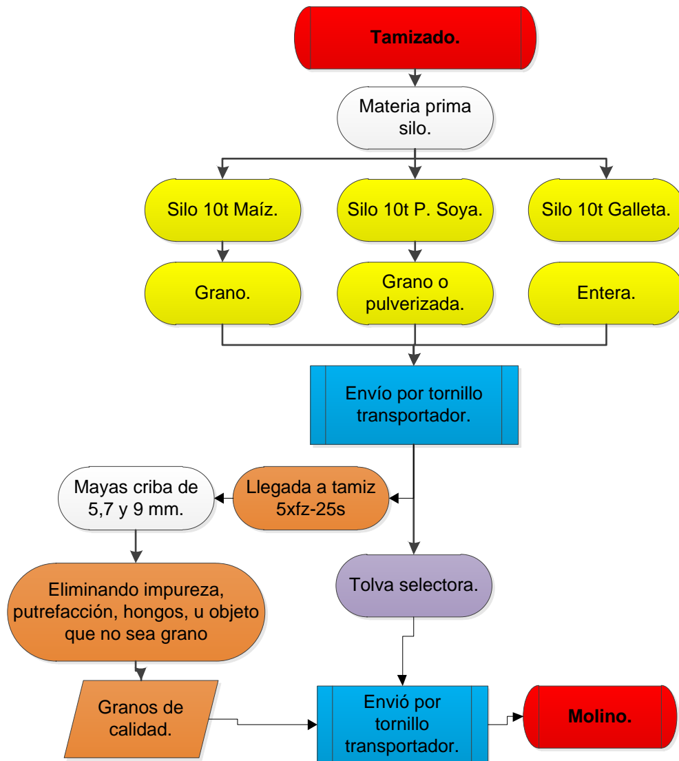
Fig.2.95 Diagrama de proceso, tamizado.
