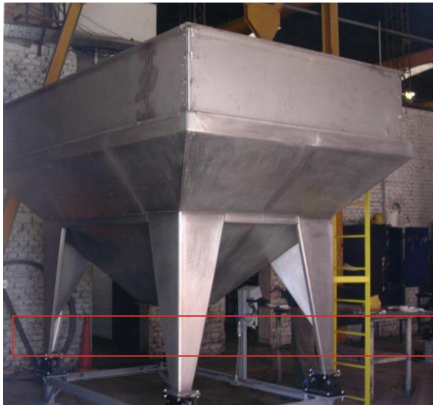
Fig. 4.38 Tolva de acero inoxidable montada en base con sensores.
