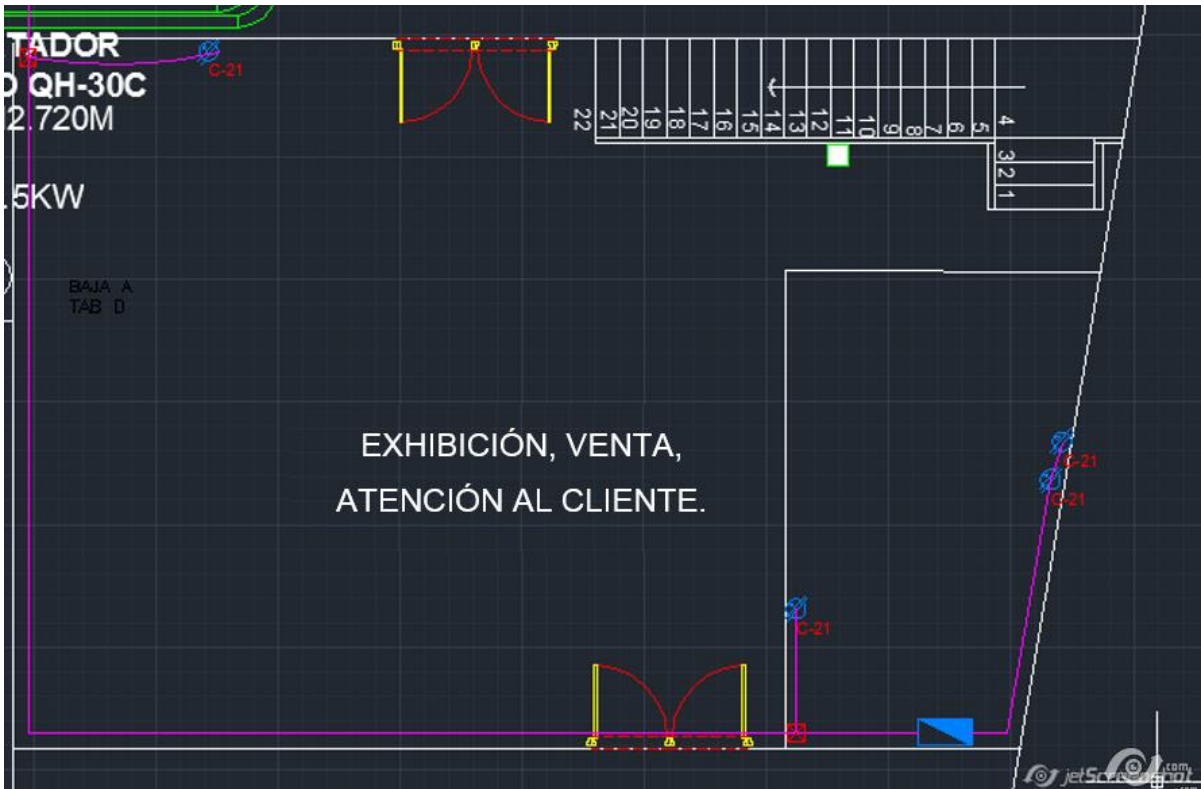
Fig. 4.25 Ubicación de contactos y tablero principal sala de exhibición y venta.
