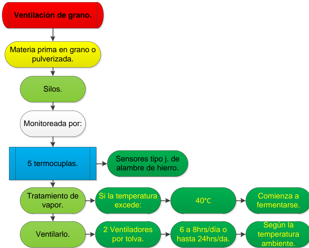
Fig.2.104 Diagrama de proceso, ventilación de granos en Silo.
