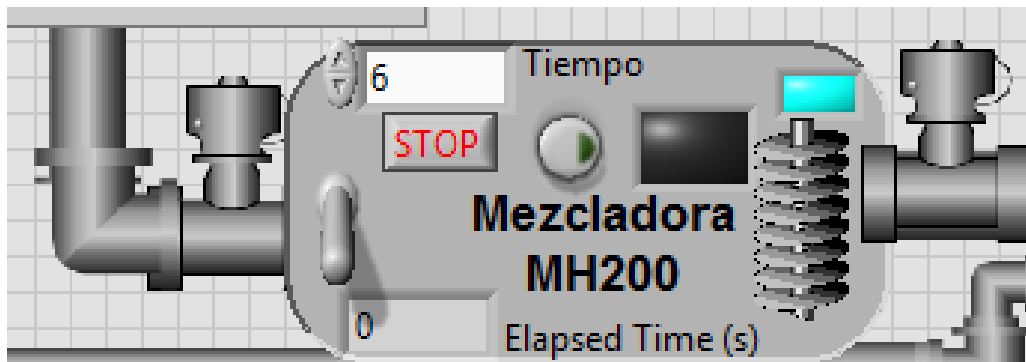
Fig. 4.7 Supervisión y control de mezcladora MH200.
