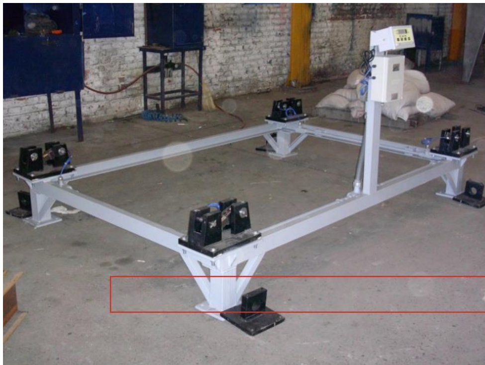
Fig. 4.36 Visualización de base en acero a montar, con sensores báscula en las esquinas.
