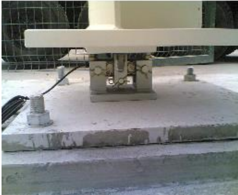
Fig. 4.39 Visualización de los sensores báscula montados en placa nivelada.
