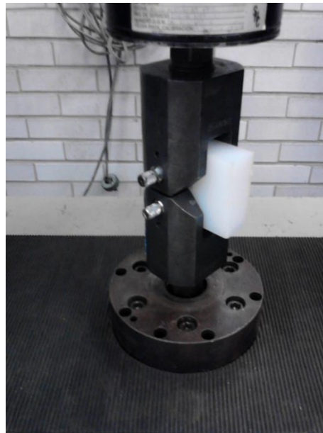
Figura 3.14. Colocación de la probeta en la máquina universal.
