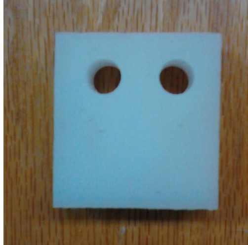
Figura 3.17. Probeta sin muesca para el factor de corrección.
