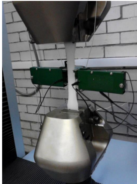
Figura 3.3. Extensómetro colocado en la región estrecha de la probeta.
