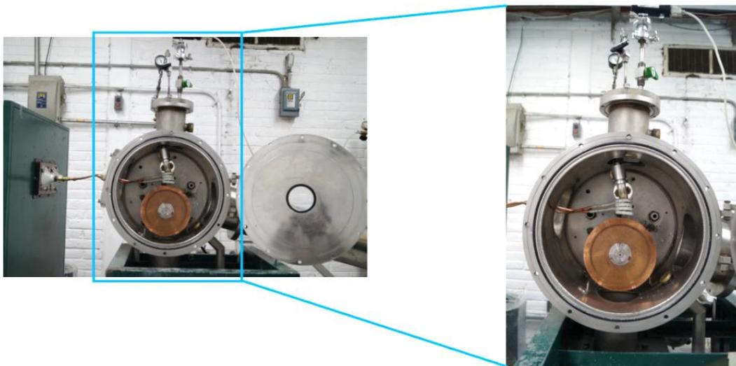
**Figura 2.7 Configuración de la cámara de melt spinning**
