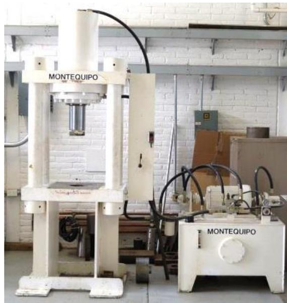
**Figura 2.9 Montequipo 140 TON (IIM-UNAM)**
