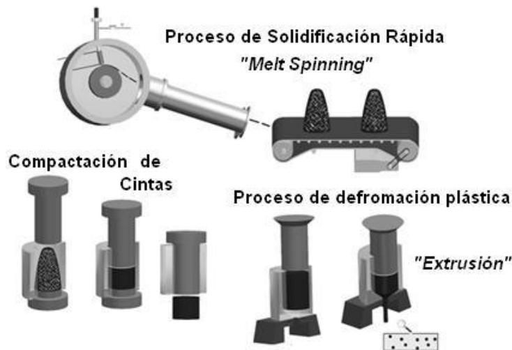
**Figura 2** Combinación de melt spinning, compactado y extrusión [10]
