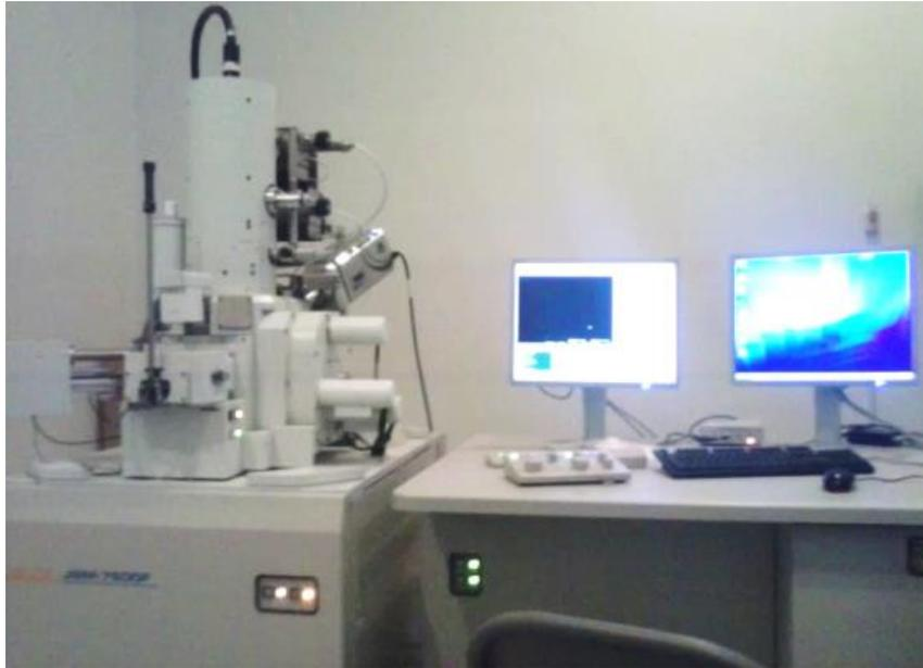
**Figura 2.17 Microscopio Electrónico de Barrido JEOL 7600F (IIM-UNAM)**
