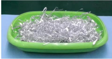
**Figura 3.2 Cintas de Al-6.1Ni (20 gramos) obtenidas por melt spinning a 20 m/s**
