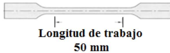
**Figura 2.27 Probeta estándar E-8 ASTM para tracción [2]**
