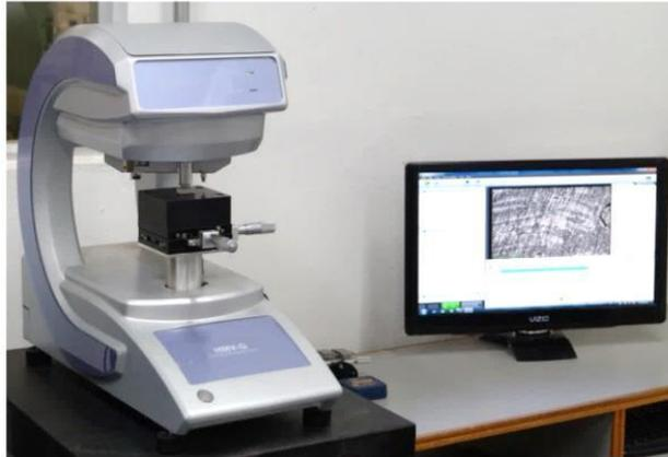
**Figura 2.31 Microdurómetro Shimadzu HMV-G (IIM-UNAM)**
