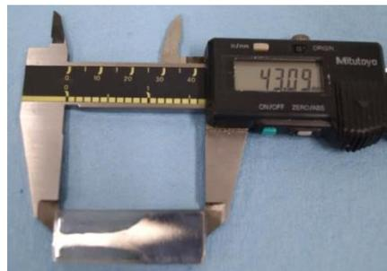
**Figura 3.4 Muestra obtenida por extrusión encapsulada, cortada por la mitad y después de metalografía**
