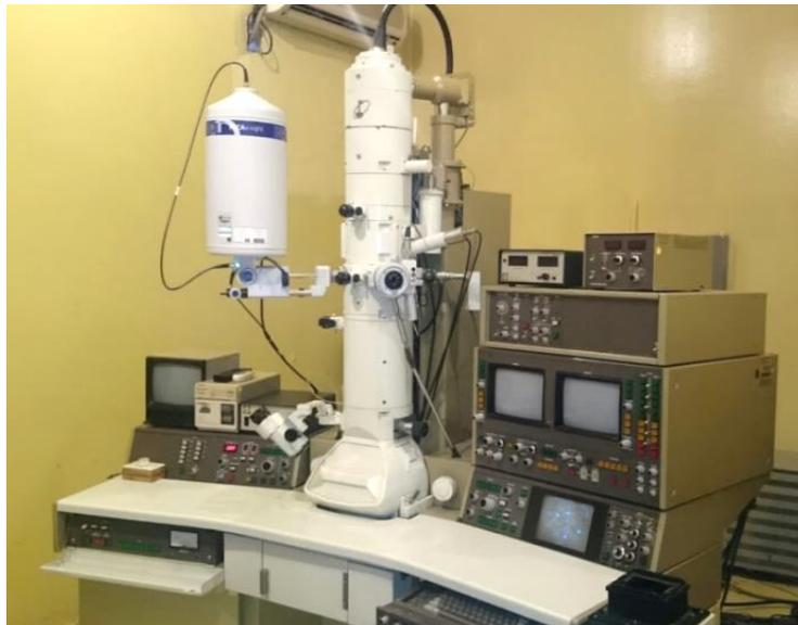
**Figura 2.21 Microscopio Electrónico de Transmisión JEOL JEM 1200-EX (IIM-UNAM)**
