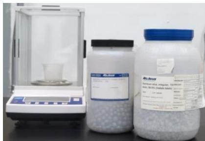
Figura 2.2 Balanza de precisión VELAB VE-300 (IIM-UNAM) con gránulos de níquel y aluminio
