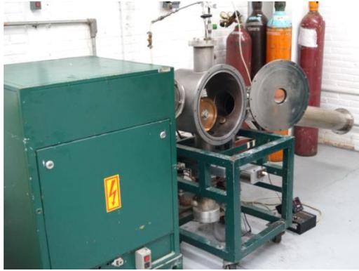
**Figura 2.6 Equipo para realizar melt spinning (IIM-UNAM)**
