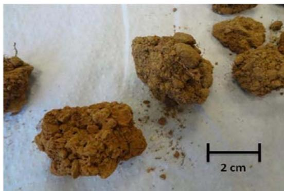
**Figura 7.** Agregados presentes en la fracción mayor a 10 mm de tratamientos con planta y estiércol. Se observan escasos agregados subredondeados, pobremente desarrollados y muy deleznable tanto en seco como en húmedo.
