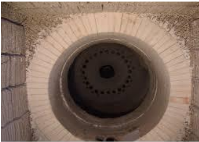
FIGURA 36-1 Los ladrillos cerámicos, se emplean en la construcción de hornos refractarios los cuales son capaces de operar a temperaturas muy altas
