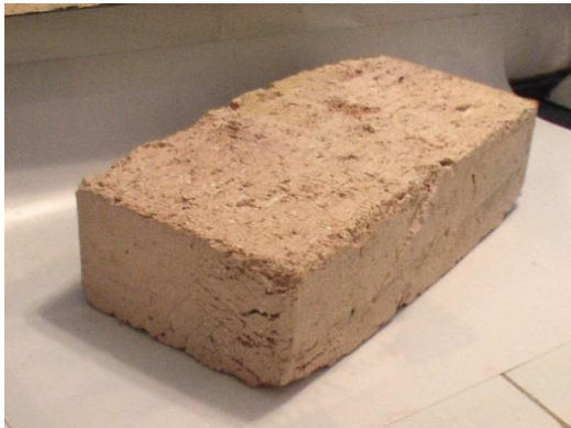
FIGURA 33-1 Ladrillo refractario, utilizado en la construcción de hornos de gran tamaño.
