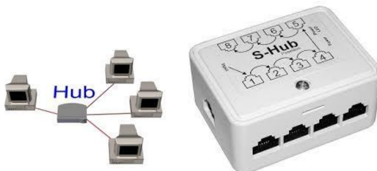
Figura 1. 28 Diagrama de un HUB en la red y ejemplo del equipo físico
