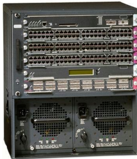
Figura 2. 7 Switch Cisco Catalyst 6500 modular multicapa con funciones de Routing & Switching
