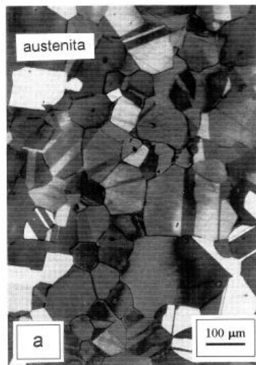
Figura 32. Micrografías de aceros inoxidables obtenidas mediante la técnica de ataque colorado [31].
