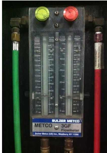
Figura 47. Relación de gases utilizado en flujómetro.
