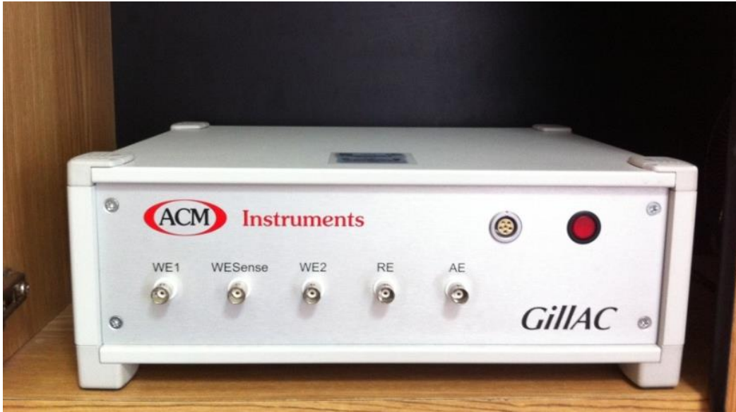
Figura 63. Potenciostato, galvanostato y amperímetro de resistencia cero con analizador en frecuencia integral de la marca ACM Instruments.
