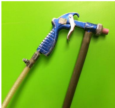
Figura 38. Pistola de granalla marca GONI serie 357
