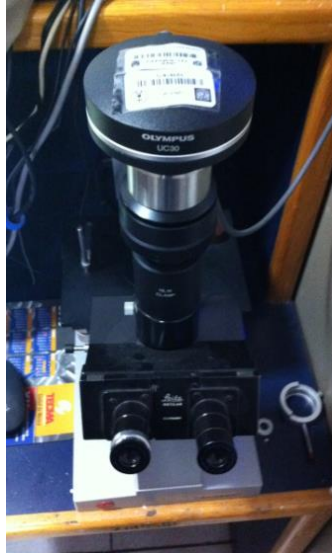
Figura 61. Microscopio Óptico “Epivert” de la marca LEITZ, acoplado a una cámara “olympus UC30”.
