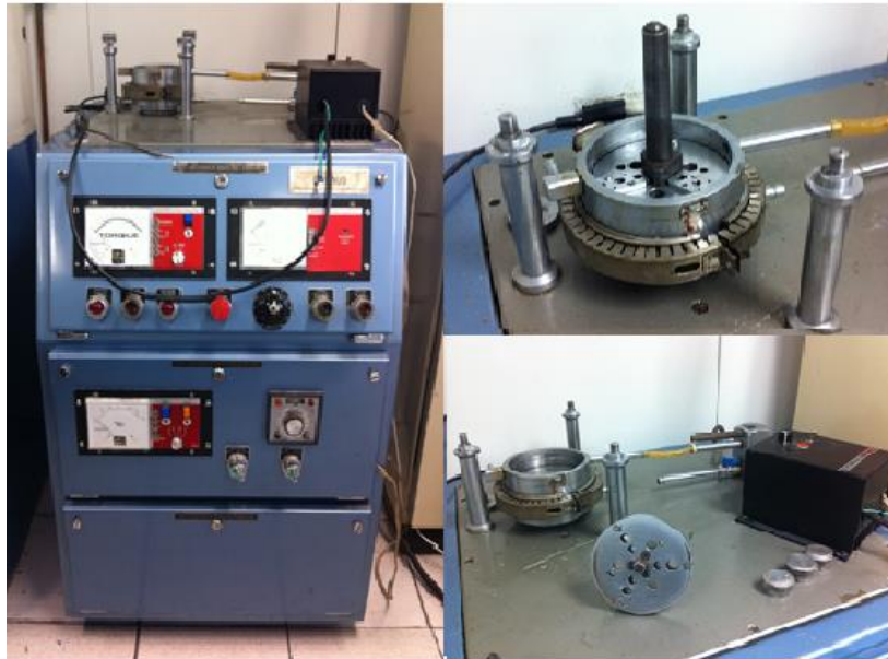
Figura 57. Equipo tribológico empleado, STCC
