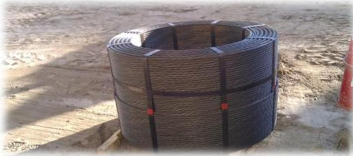
*Figura 26. Bobina de cable torón de 15 mm.*
