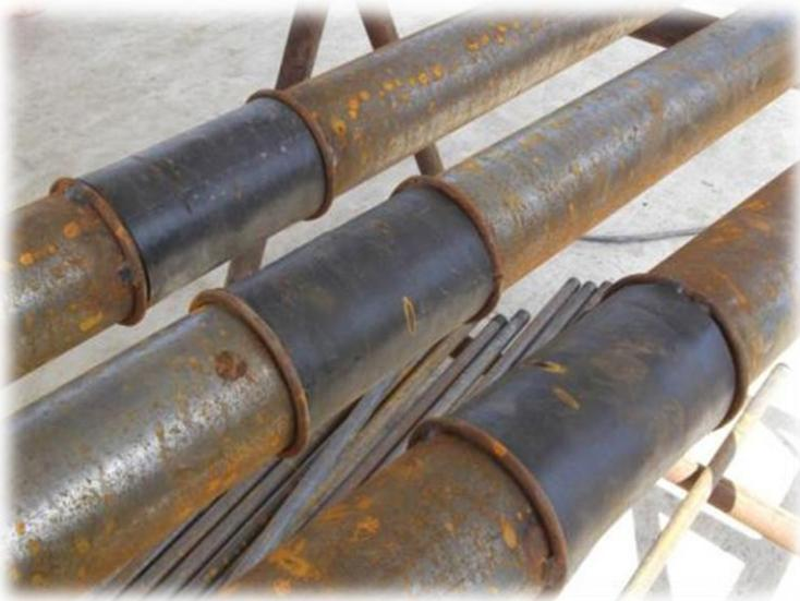
*Figura 65. Obturador inflable (ancla permanente).*
