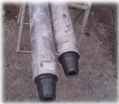
*Figura 54. Barras empleadas para la perforación.*
