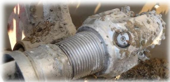
*Figura 52. Broca tricónica 5 7/8" instalada en barra de perforación.*
