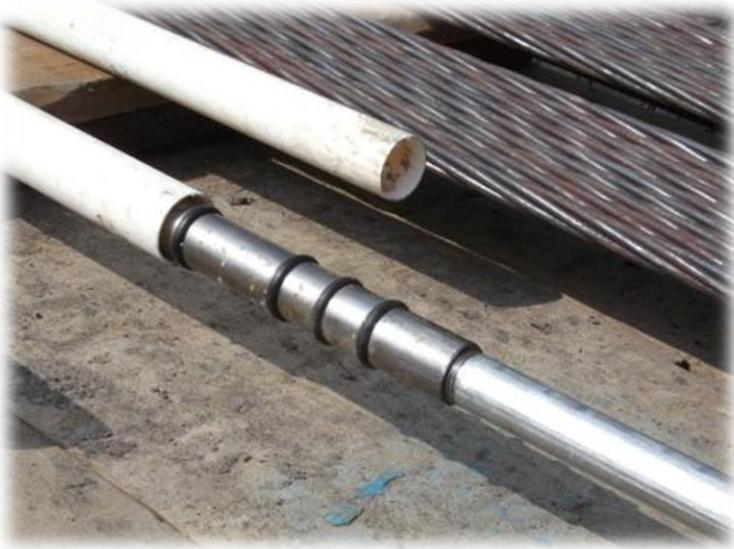
*Figura 64. Tubería y obturador (ancla temporal).*
