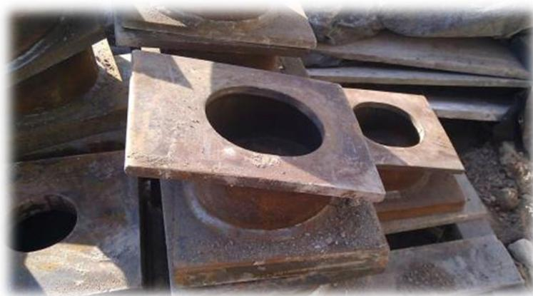
*Figura 71. Silleta con inclinación de 15°.*
