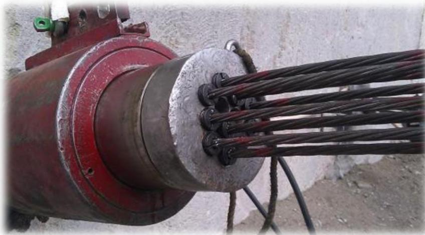
*Figura 74. Montaje de gato con capacidad para 10 torones*
