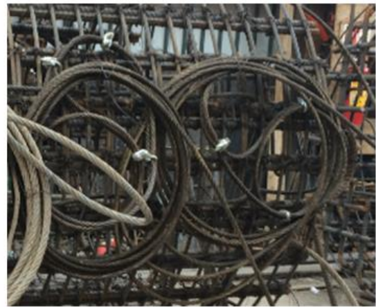
Fig. 3.18, Estrobos para el Trampeo Definitivo
