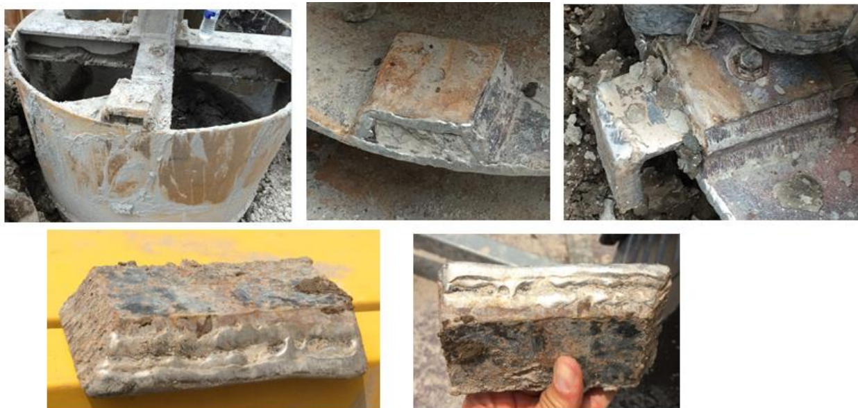
Fig. 2.36, Dientes (Rimas), Porta Dientes (Caja Metálica)
