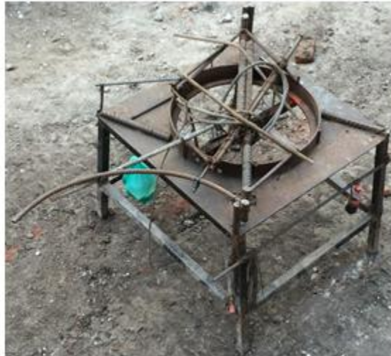
Fig. 3.6, Mesa de Habilitado de Acero
