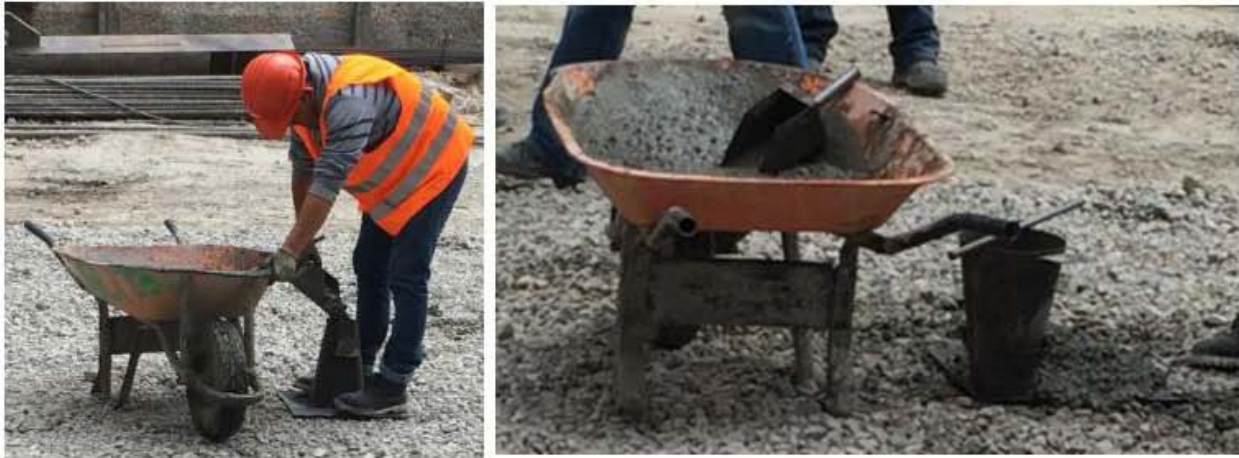
Fig. 4.15, Prueba de Revenimiento
