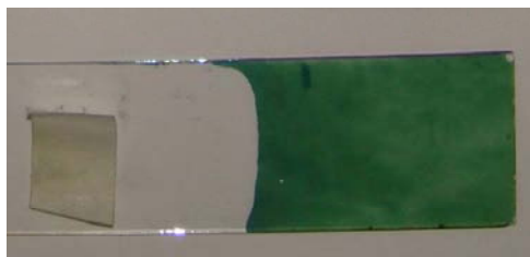
Figura 3.4 Película depositada sobre el sustrato de vidrio.
