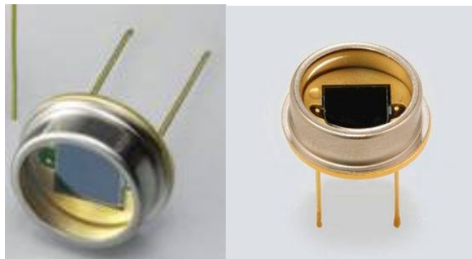
Figura 3.13. Detector de referencia y medición Edmund Optics u54-034.
