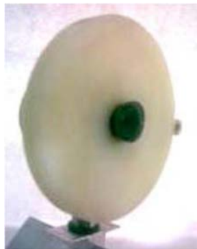
Figura 3.9. Polarizador sobre engrane de nylon usado en el sistema óptico.
