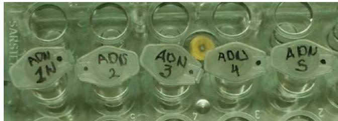
Figura 8. ADN genómico a utilizar como molde para la reacción de la PCR
