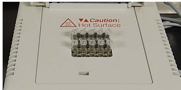
Figura 9. Colocación de los tubos de 0.2mL en el Termociclador.
