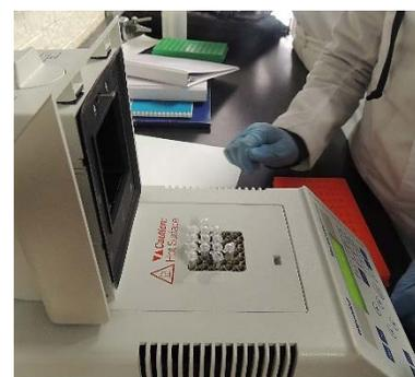
Figura 17. Programación del Termociclador y colocación de las muestras.
