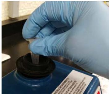
Figura 5. Homogeneización de los reactivos usando Vortex.
