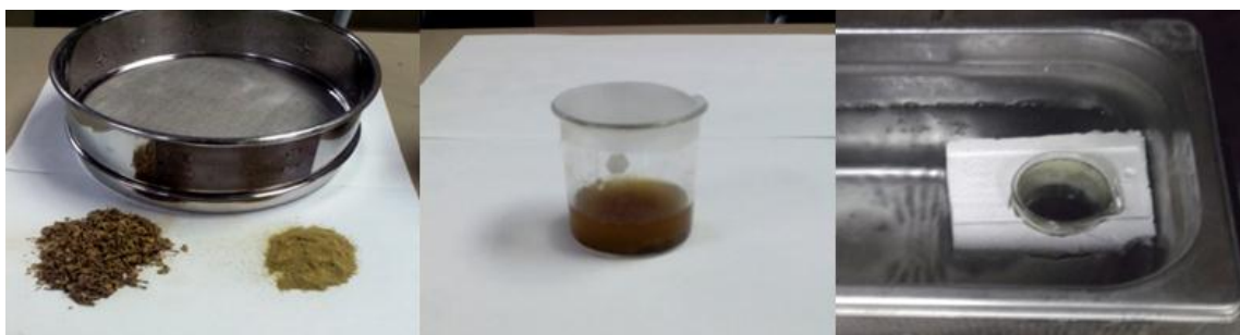
Figura 4.2 Proceso de extracción asistida por sonicación.
