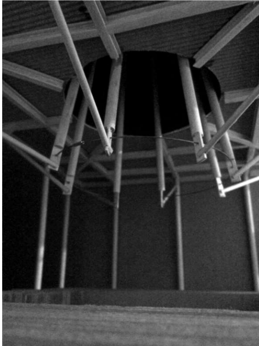
Vista de las ocho columnas centrales, los tensores perimetrales y el anillo de compresión
