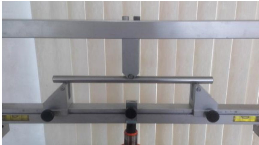
Figura 6.5 Ajuste de la probeta con el perno del punzón.
