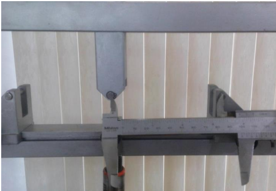
Figura 6.4 Ajuste de la distancia entre pernos.
