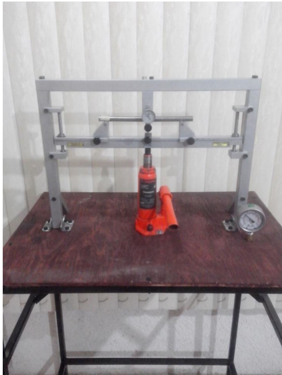
Figura 3.21 Fotografía del equipo para la prueba de flexión.
