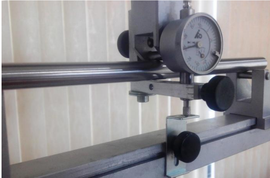
Figura 6.7 Ajuste del indicador de carátula con la palanca.
