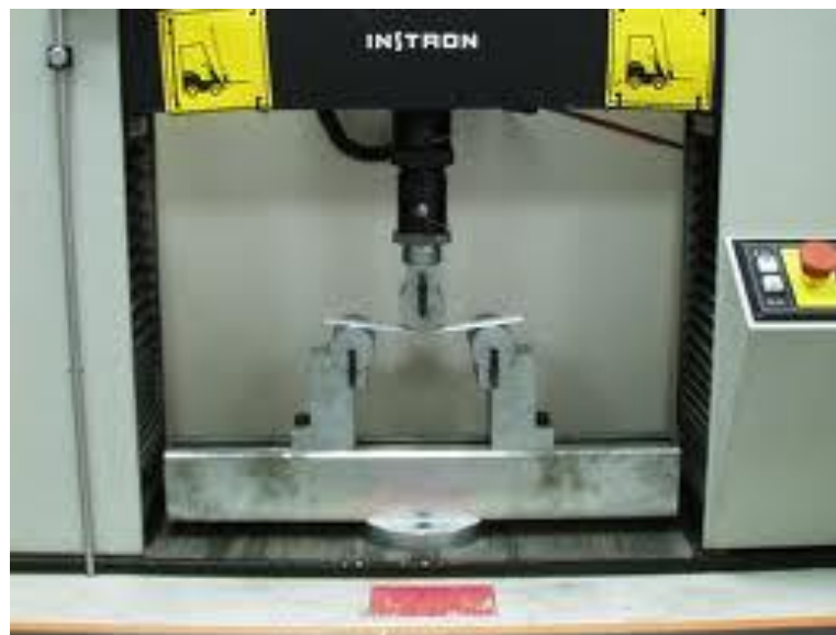
Figura 2.4 Mesa deflexión de una máquina universal, con la probeta colocada.
