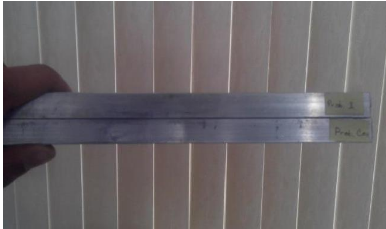
Figura 6.8 Comprobación de la deformación de la probeta sometida a flexión (arriba) con respecto de la probeta de control (abajo).
