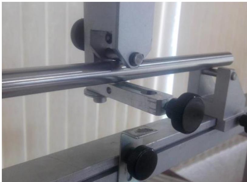
Figura 6.6 Ajuste del soporte del indicador de carátula con la probeta.
