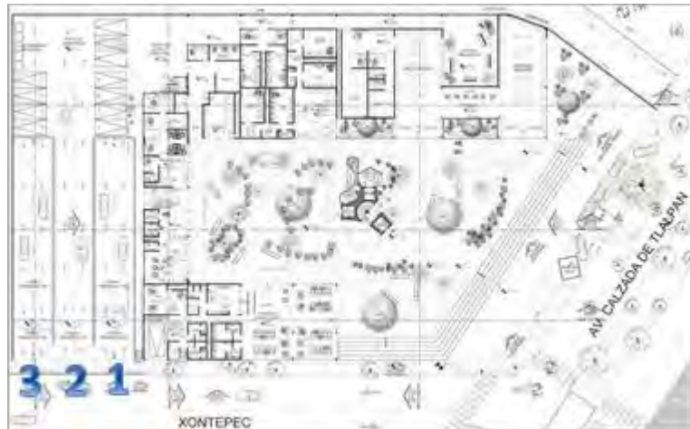
Zonificación de circulaciones vehiculares donde 1 y 2 son acceso y 2 y 3 son salidas.
