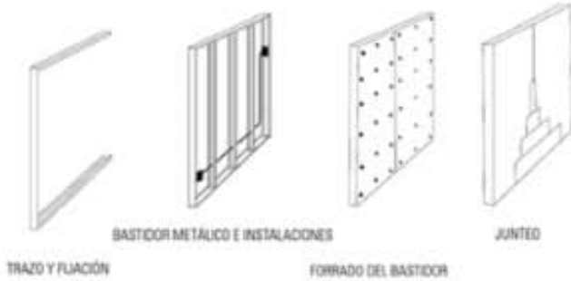
DETALLE COLOCACION DE TABLARROCA
