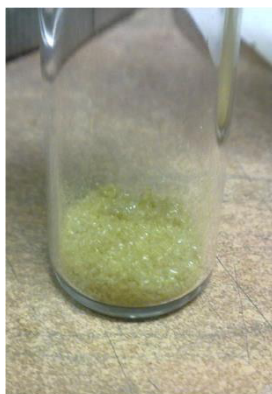
Figura 10. Fotografía de la oleuropeína obtenida a partir de hojas de olivo. Características físicas: sólido amarillo, punto de fusión: 87 a 90 °C (Shasha, Leibowitz 1961)
