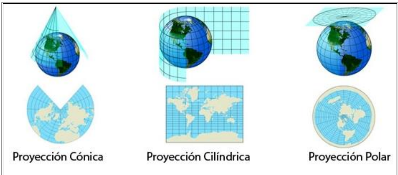
Figura 1.1 Esquema de las tres principales proyecciones cartográficas proyección cónica (útil para latitudes polares), proyección cilíndrica (útil para obtener un mapa de todo el mundo) y proyección polar o azimutal (útil para cartografiar zonas específica) (tomado de Velázquez., 2013).
