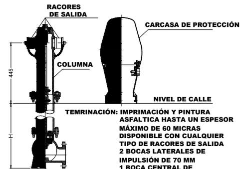
TEMRINACIÓN: IMPRIMACIÓN Y PINTURA ASFALTICA HASTA UN ESPESOR MÁXIMO DE 60 MICRAS DISPONIBLE CON CUALQUIER TIPO DE RACORES DE SALIDA
