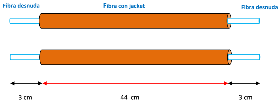
Figura 3.1 Esquema de los trozos de fibra óptica para ser empalmados
