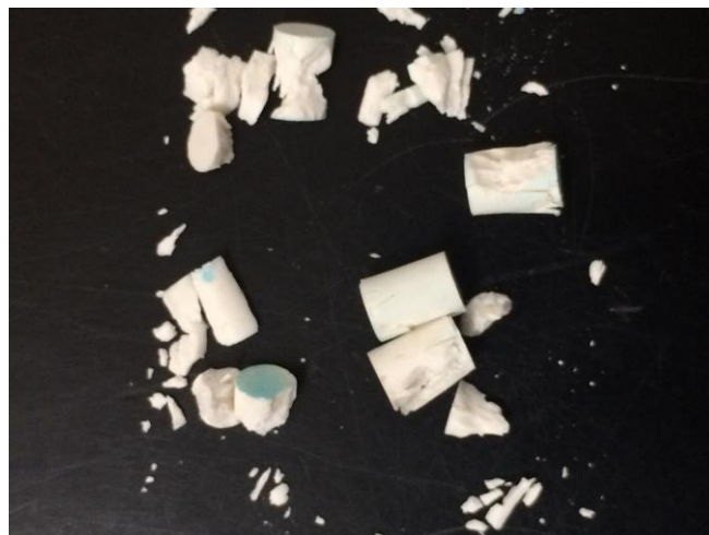
Fig. 14 Muestras de Mirafil después de la prueba de resistencia compresiva con Instron
