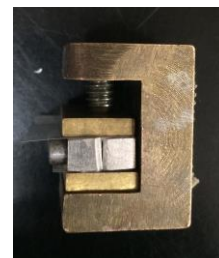
Fig. 5 Molde prefabricado y lingotes metálicos prensados
