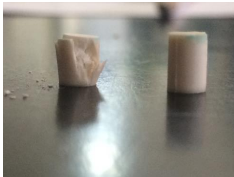
Fig. 12 Muestra de Mirafil (después de la prueba de resistencia compresiva con instron a la izquierda y antes a la derecha)
