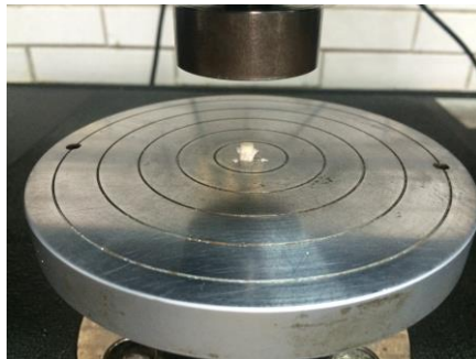
Fig. 11 Muestra de Mirafil después de la prueba de resistencia compresiva
