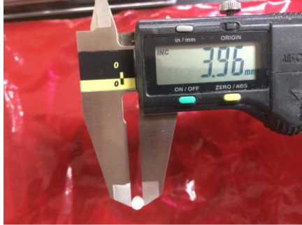
Fig. 9 Medición con Vernier de una muestra de Vitrebond
