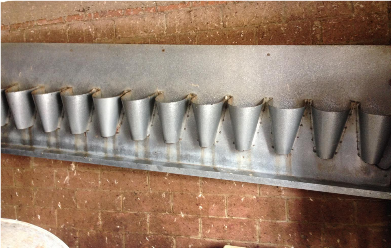
Figura 12. Conos de material galvanizado.
