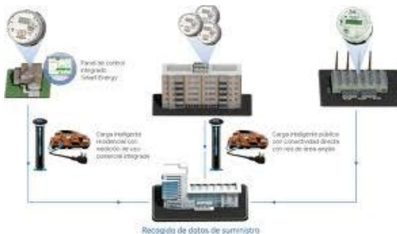
Fig.41. Estructura y alcance de los medidores inteligentes.
