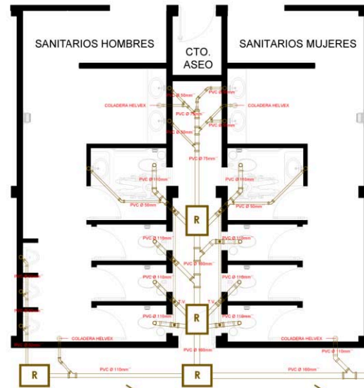
PLANTA ARQUITECTONICA- MODELO 3 INSTALACION SANITARIA
