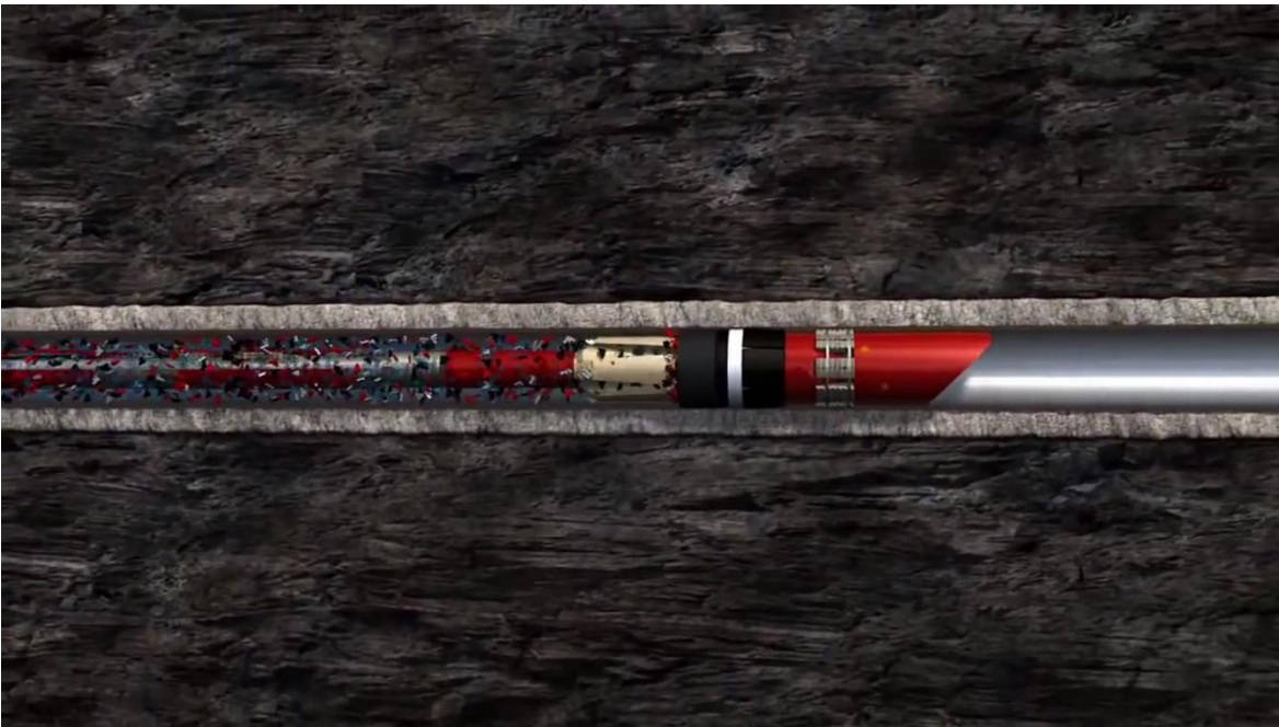
Figura 5.8 Molienda de los Tapones (Weatherford, 2014)
