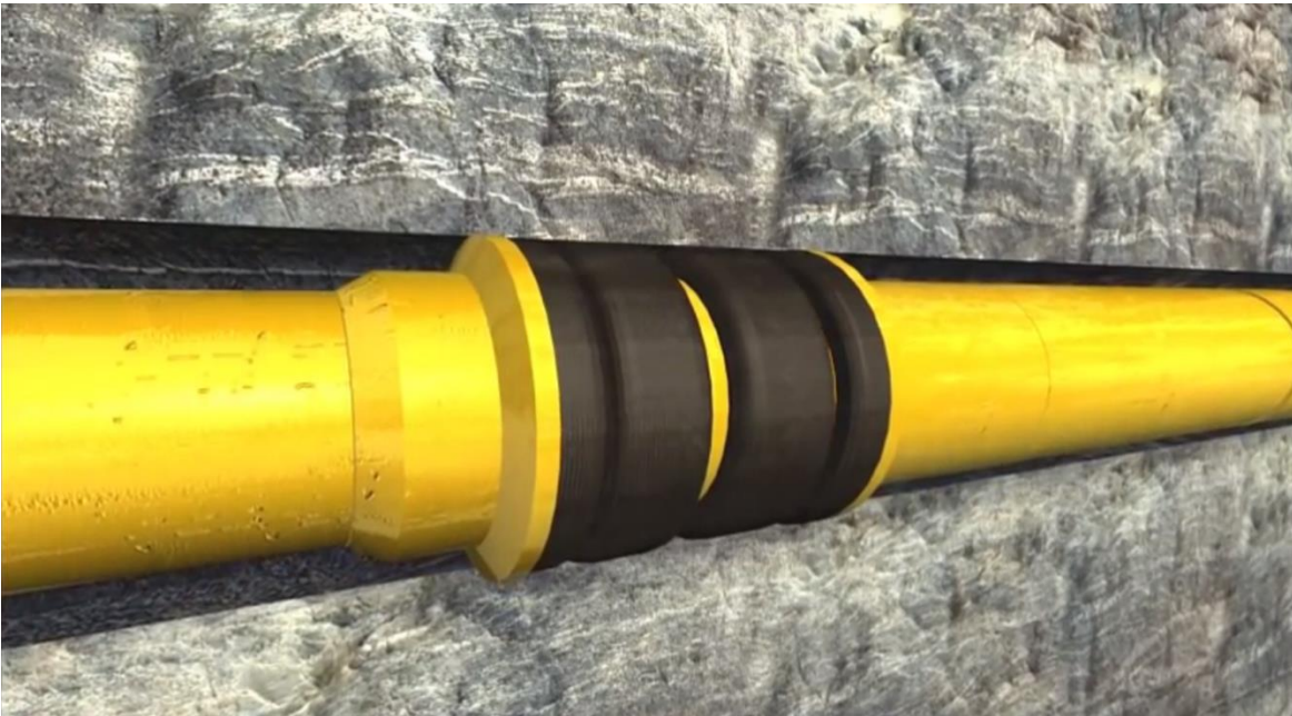
Figura 5.10 Instalación de los Empacadores (Baker Hughes, 2010)
