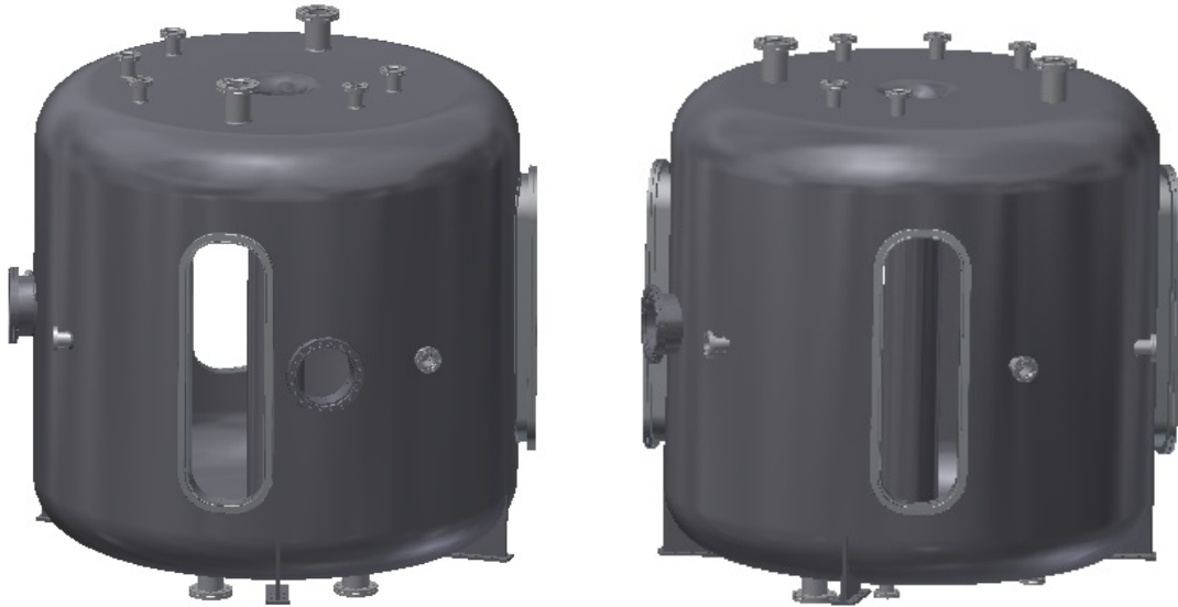
Figura 53. Vista general de la cámara de vacío. La imagen de la izquierda esta rotada 70° con respecto al eje de la máquina.
